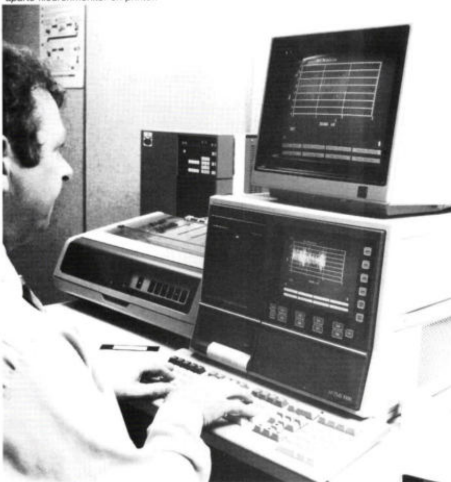
Afb. 2. De H-TMS 3000/30 is de meest uitgebreide versie met een extern toetsenbord en een aparte kleurenmonitor en printer.
