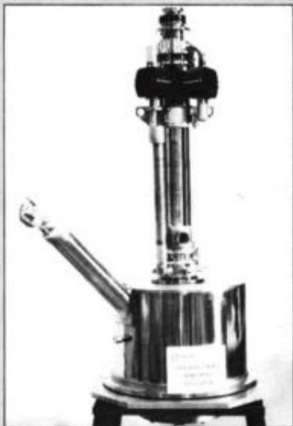
Varian gyrotron VGE-8086. Deze microgolfvermogensbron levert 200 kW op 60 GHz.
