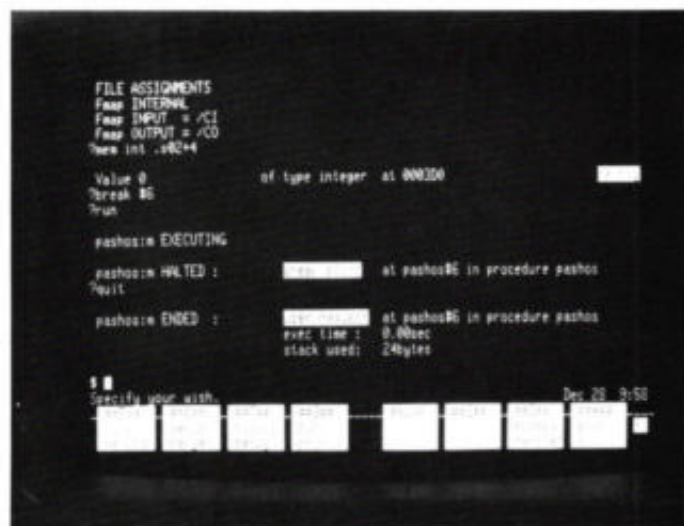
Fig. 8. Controle van het ontwikkelproces van (in dit geval) een Pascal-programma m.b.v. de acht functietoetsen.
