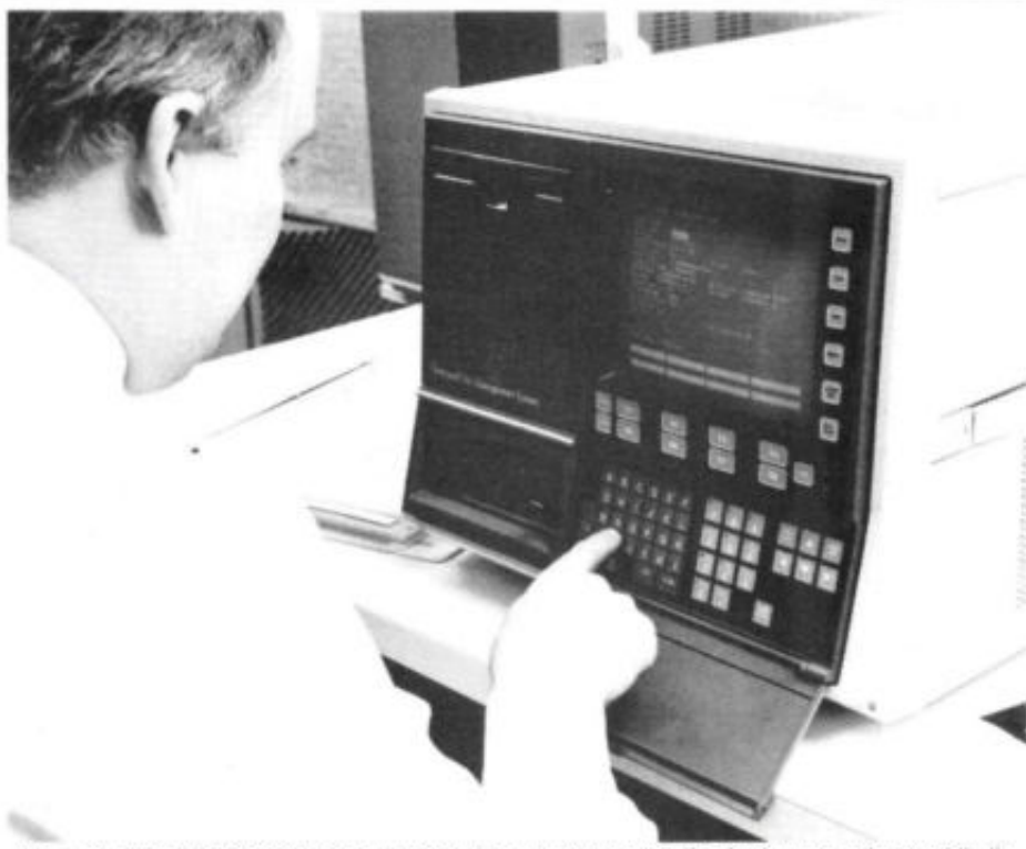
Afb. 1. De H-TMS 3000/10 is een universeel meetsysteem van de vierde generatie waarbij alle onderdelen, die nodig zijn voor het gehele meetproces, in één behuizing zijn ondergebracht.
